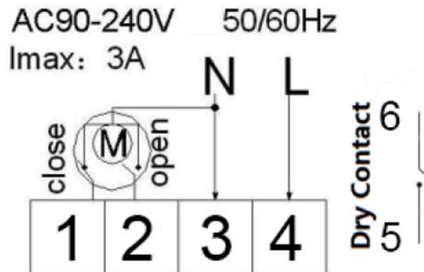
Diagrama de fiação para aquecimento de água e aquecimento por caldeira a gás, sem contato (desconexão quando a válvula elétrica fecha).
